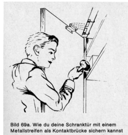
Bild 69a. Wie du deine Schranktür mit einem Metallstreifen als Kontaktbrücke sichern kannst
